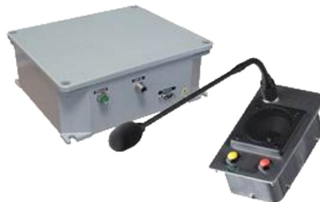
L'elemento base per la realizzazione di questa funzione è l'amplificatore audio di potenza che riceve tramite la LAN gli stream audio da riprodurre e pilota gli altoparlanti installati nell'area passeggeri con una linea audio a 100V in grado di fornirne una potenza di 80W.
