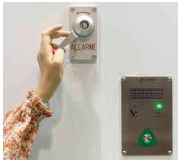
Lo scopo primario del PAS è evitare l'arresto incontrollato del convoglio in zone pericolose quando viene attivato il freno di emergenza da parte di un passeggero.
